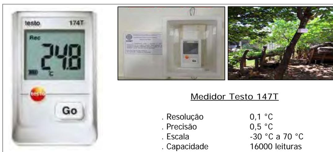
**Figura 28** – Equipamento para medições fixas nos postos de controle.
