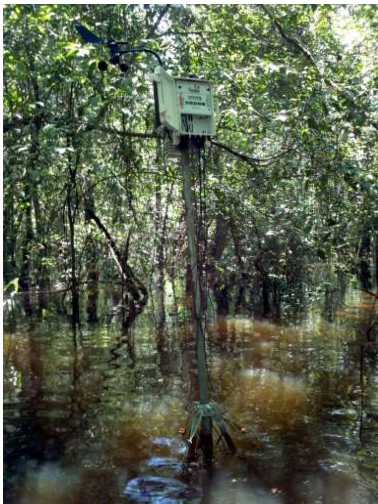
Figura 5. Estação micrometeorológica (WatchDog 2000, Spectrum Technologies, USA).
