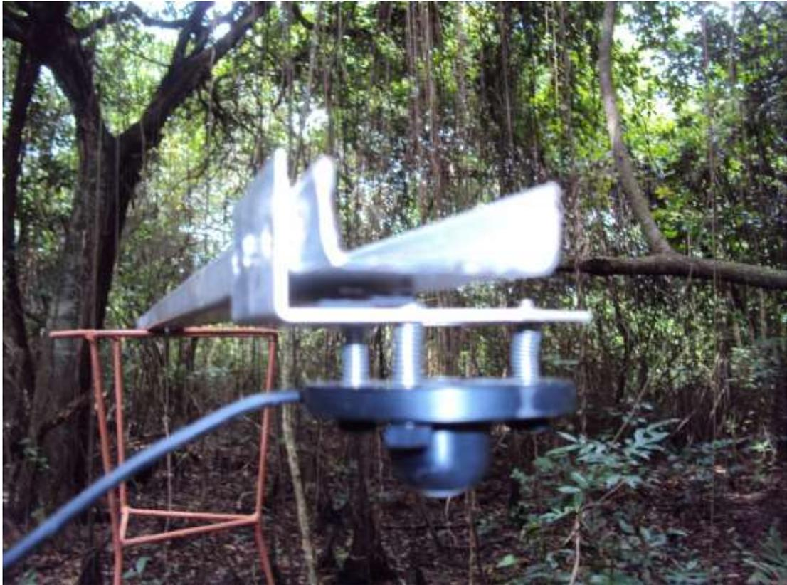
Figura 6 - Piranômetro instalado no suporte virado para baixo para medição de radiação refletida pelo solo.
